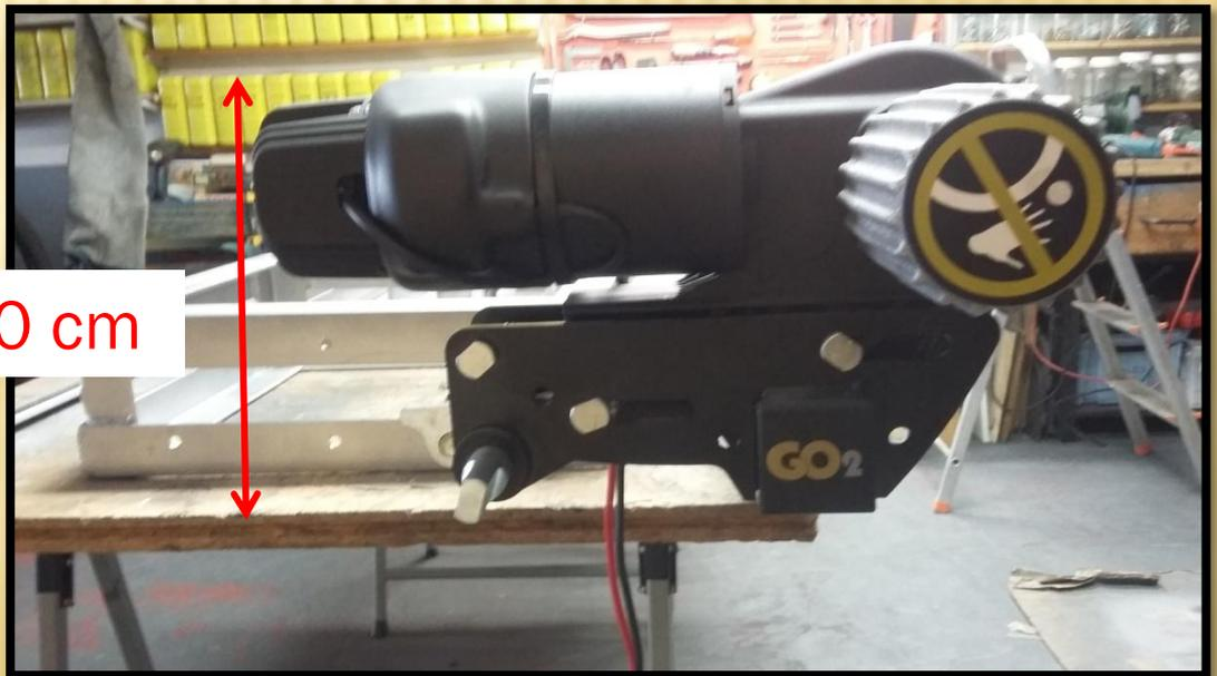
Sur un châssis de caravane les longerons sont sur le bord près des roues, ce qui n'est pas le cas sur la remorque (43 cm du bord de caisse ). Ne pouvant pas mettre les fixations sur les longerons, j'ai fabriqué un support qui va permettre au moteur le meilleur positionnement possible.
