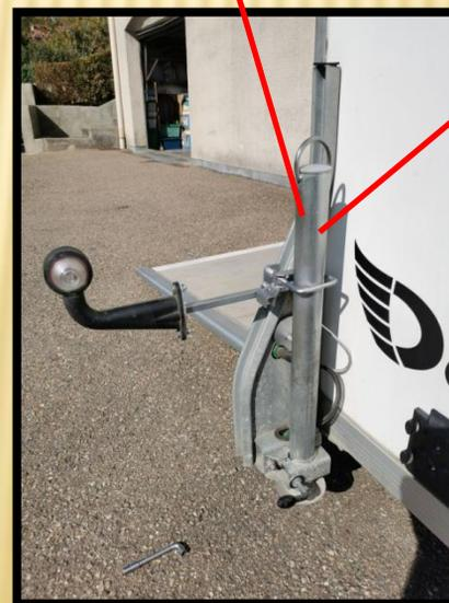
C'est la béquille stabilisatrice qui sert par l'intermédiaire de la pièce de blocage de verrouillage du support amovible
