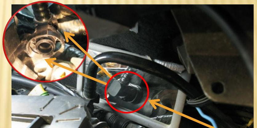
Appuyer sur l'anneau pour déboîter le raccord derrière le répartiteur d'admission (côté boîtier filtre à air) et tirer sur le tuyau.
