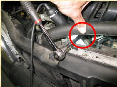
Débrancher et déplacer les **câbles** du démarreur
