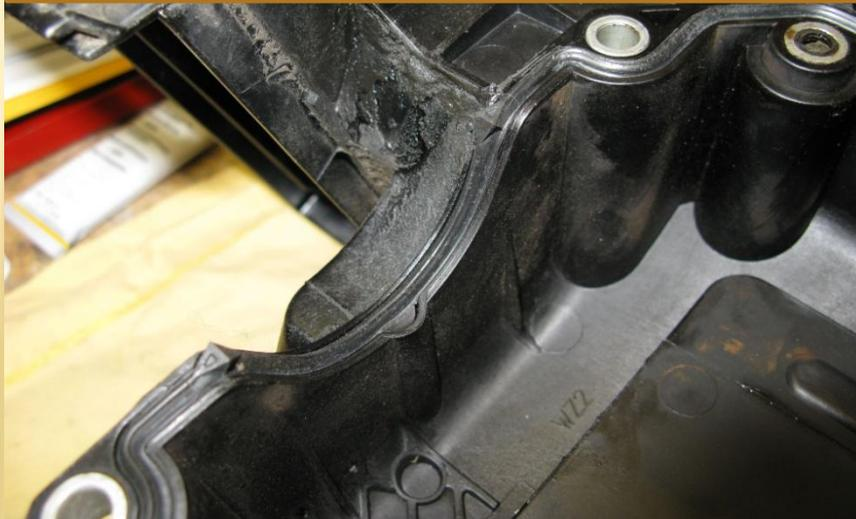
Et voilà pour la dépose du couvre culasse et l'échange du joint.
