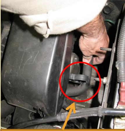
Décrocher la tuyauterie sur le côté
