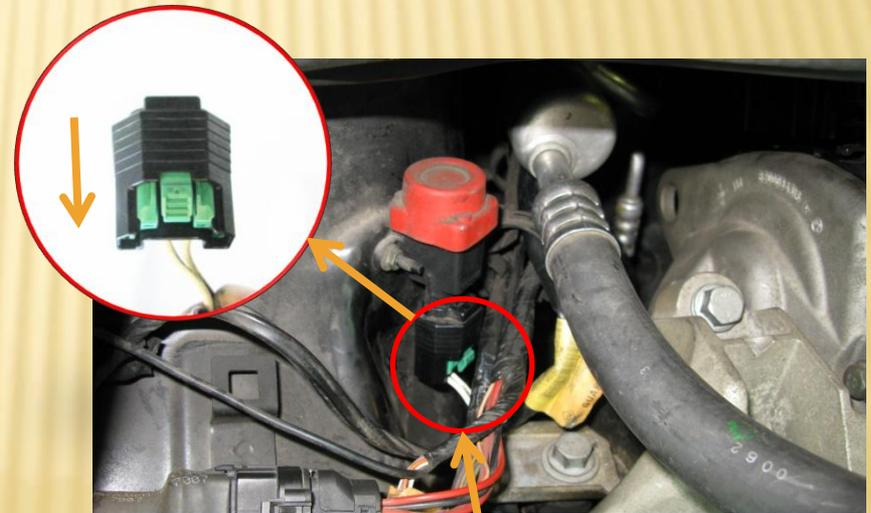
Déconnecter le raccord du contacteur d'inertie. Faire descendre la languette verte
