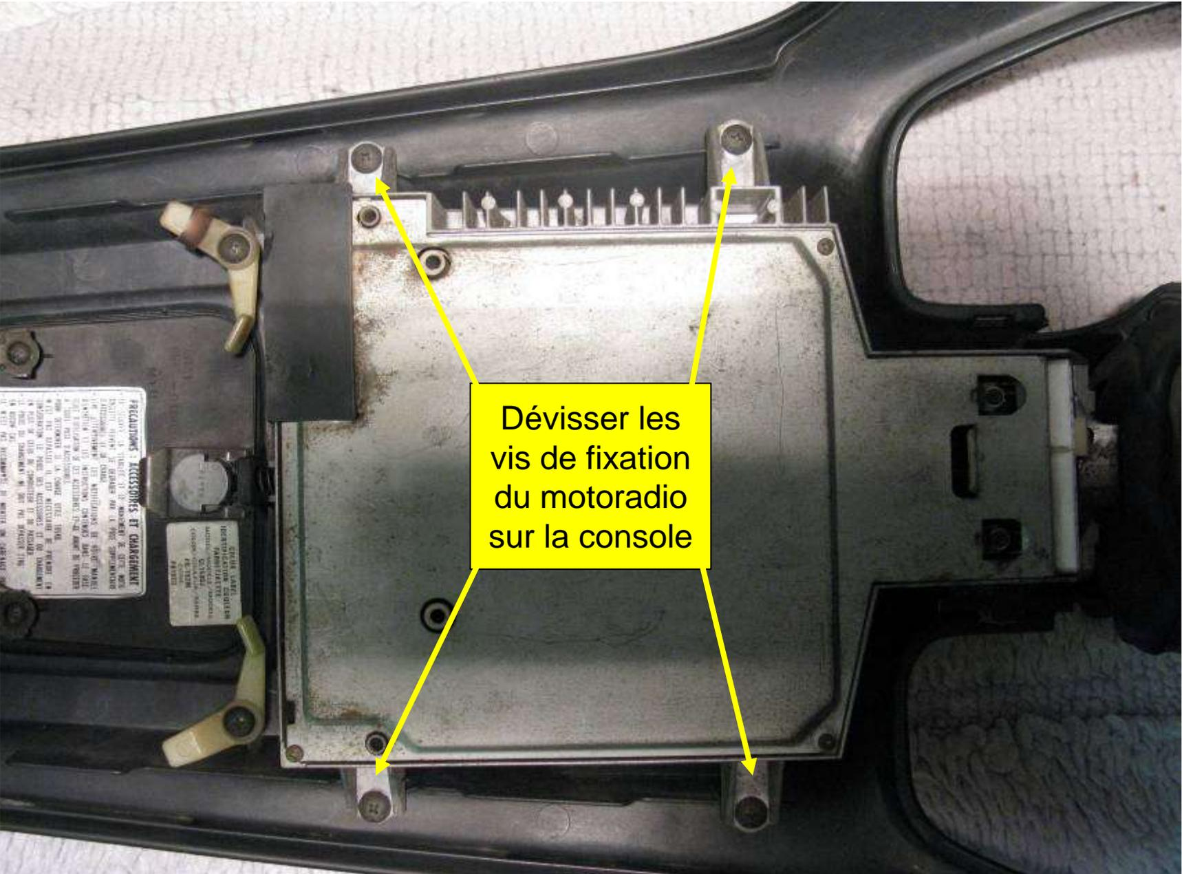
Dévisser les vis de fixation du motoradio sur la console
