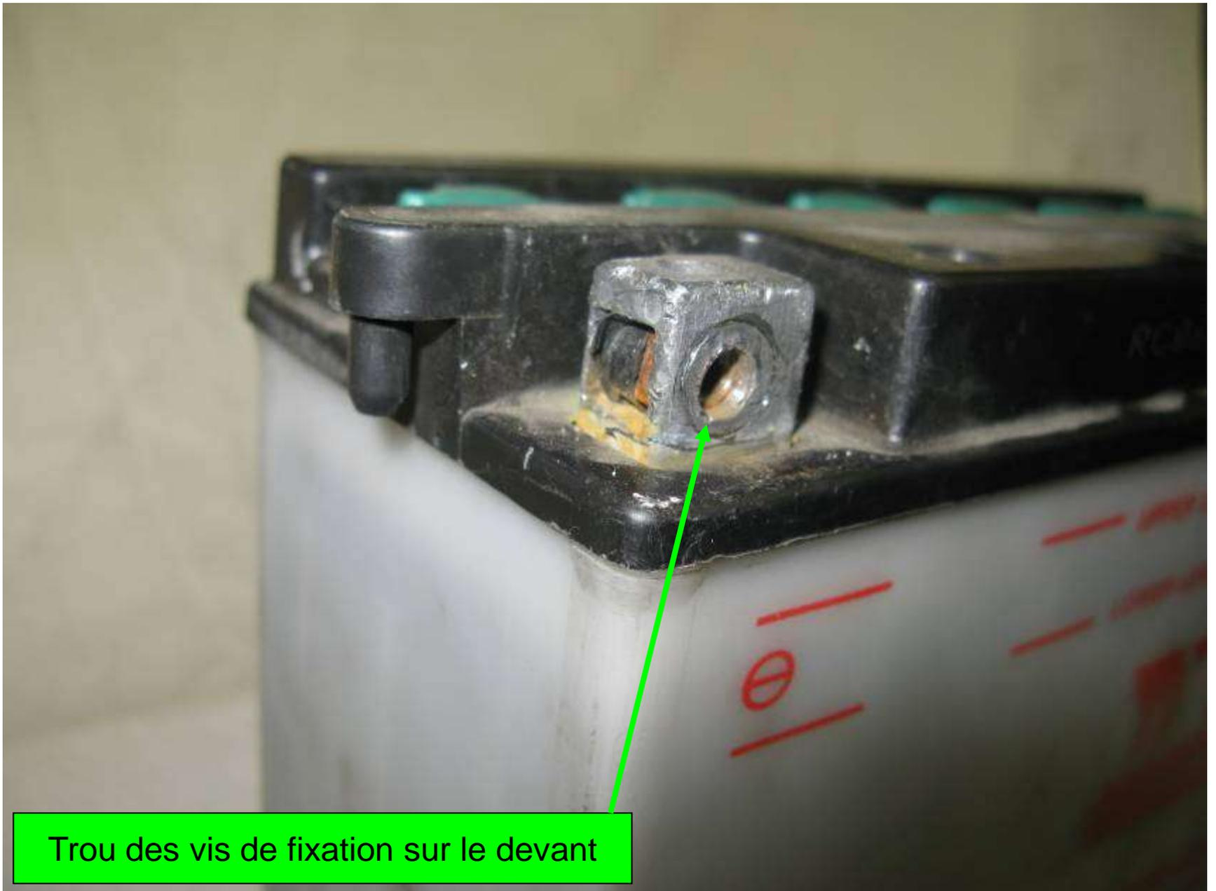
Trou des vis de fixation sur le devant
