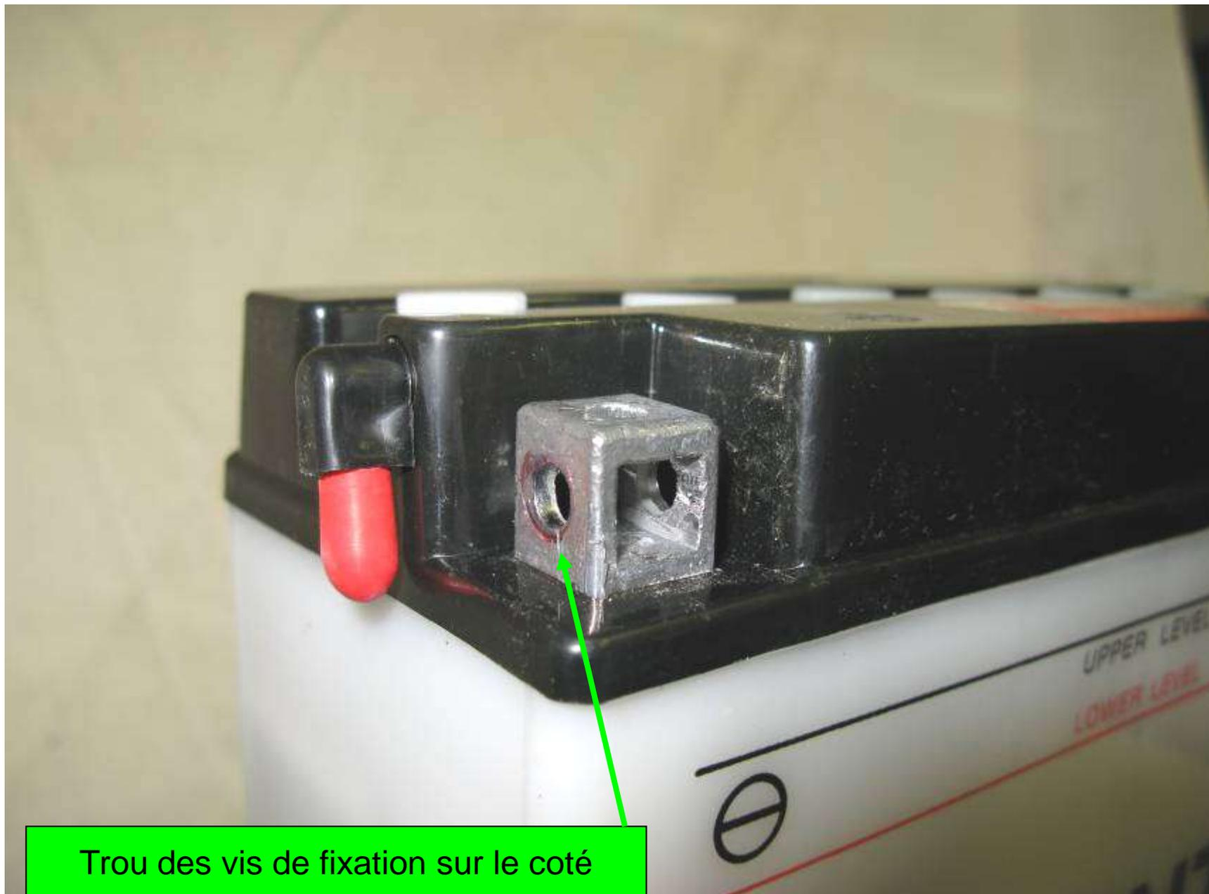
Trou des vis de fixation sur le coté
