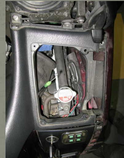
Dépose du casier de carénage droit
