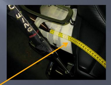
Fixer l'aileron de manière à affiner les mesures des deux côtés. Tracer les contours des fixations ( avec un crayon plat la trace est plus précise )
