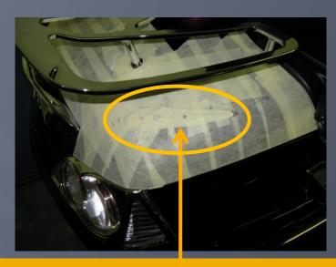
Positionner les patrons sur l'emplacement des contours. Ajuster par rapport aux mesures
