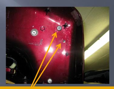
Mettre une vis de fixation de chaque côté et contrôler que les trous coïncident
