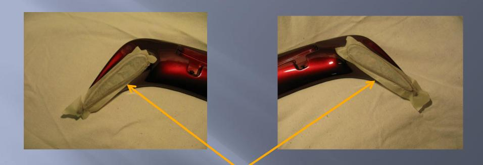
Appliquer de l'adhésif de peintre sur les fixations de l'aileron. Dessiner les contours (main levée sans trembler). Percer les trous
