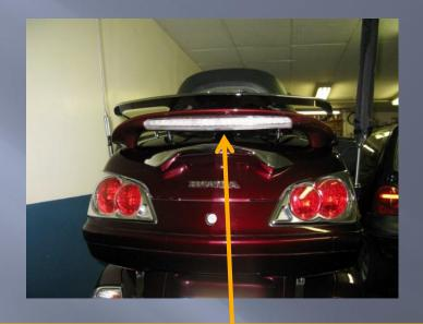
Poser l'aileron en passant le câble électrique dans le trou du milieu
