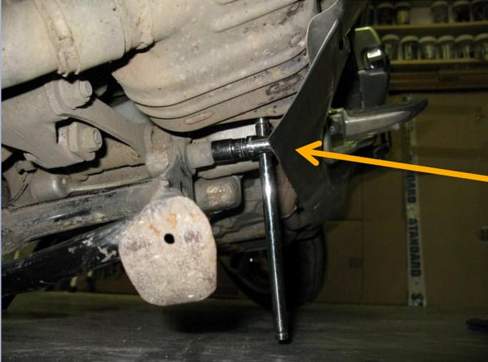
Déposer la vis en dévissant dans le sens des aiguilles du montre ( pas à gauche ). Elle est montée au « frein-filet » et elle peut-être difficile à débloquer car il n'y a pas beaucoup d'espace. Ici elle résiste = dépose du cache latéral
