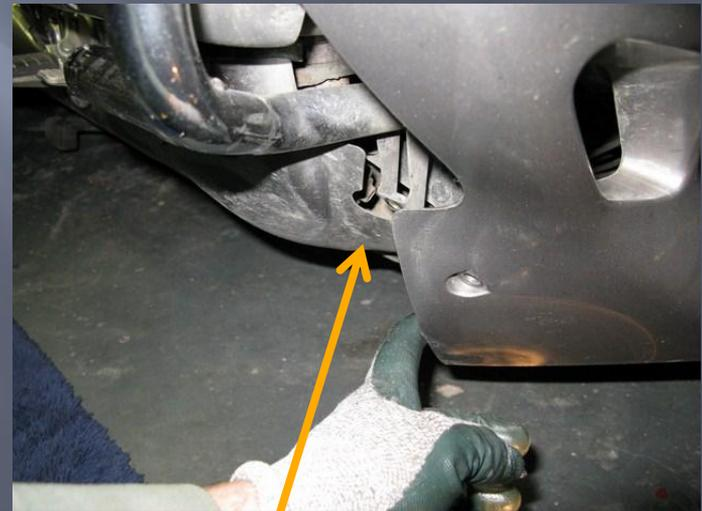
Desserrer la vis derrière le cache avant qu'il faut débloquer et légèrement écarter
