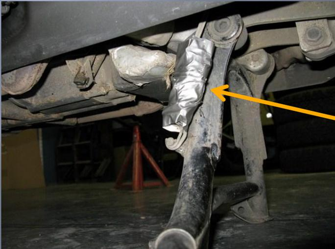
Mettre la moto sur la béquille centrale. Ecarter les spires des ressorts avec un tournevis plat et insérer des petites vis. Scotcher l'ensemble pour éviter les mauvaises surprises.
