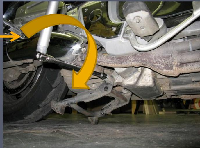
Et voilà. Il ne reste plus qu'à mettre la béquille courte. ATTENTION au remontage car il y a des entretoises différentes à droite et à gauche avec des méplats sur la fixation du support de la béquille
