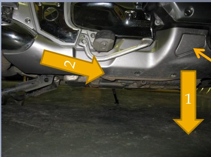
Descendre l'avant du cache latéral et le pousser vers l'avant pour décrocher la partie arrière de son support. ATTENTION au câble d'ouverture du volet
