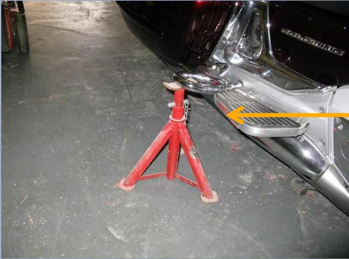
Mettre une petite chandelle du côté inverse de la béquille latérale. Caler la moto pour qu'elle n'avance ni ne recule. Pencher doucement la moto sur la chandelle. Ainsi il y a un plus grand espace pour déposer la vis BTR
