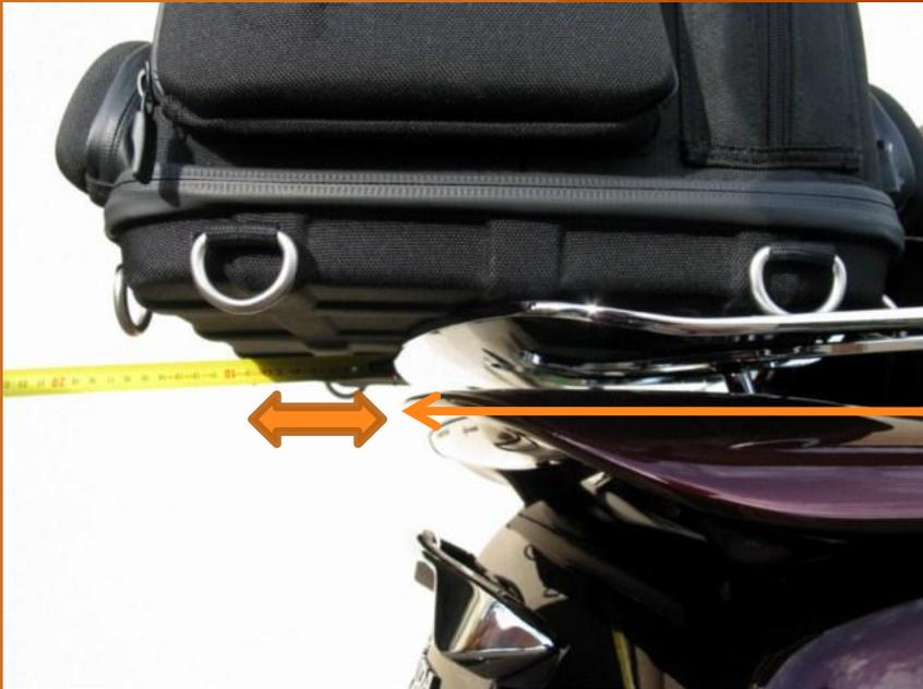
Quand le sac repose directement sur le porte-bagages il a un porte-à-faux d'une bonne dizaine de centimètres (pas terrible pour la stabilité et la fixation ...).
