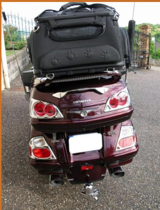
Il s'agit d'installer le sac (Pet Palace) sur le porte-bagages de manière stable, sans que le capot du coffre supporte tout le poids (sac 4kg + chien 6kg) sur les 4 pieds du porte-bagages, ce qui représente une petite surface de contact donc une pression assez conséquente. Le capot du coffre risque de se fissurer voir de casser ...
