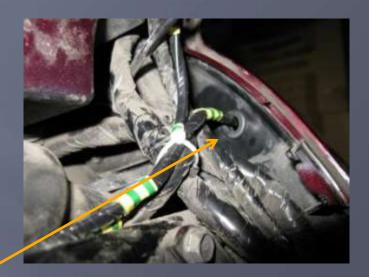
Pour éviter les infiltrations d'eau, au niveau des passes-fils, j'ai mis du mastic de garniture de portière
