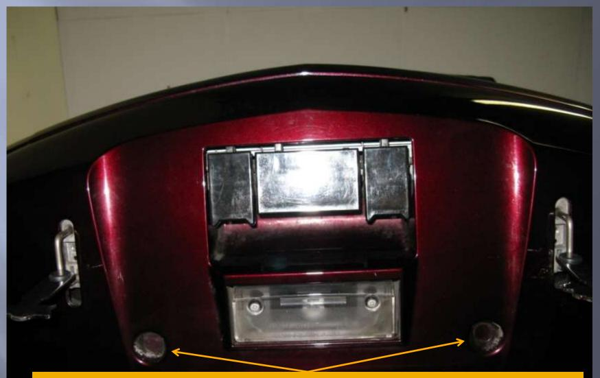
Démonter le cache sous le top-case en dévissant les vis de fixation et tirer vers l'arrière en écartant un peu les côtés (attention aux clips en plastique sur les côtés, voir la revue technique)
