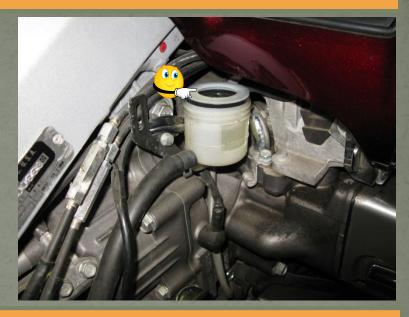
Soulever les gaines pour que le bouchon soit bien placé au dessus de la membrane et du réservoir et fermer
