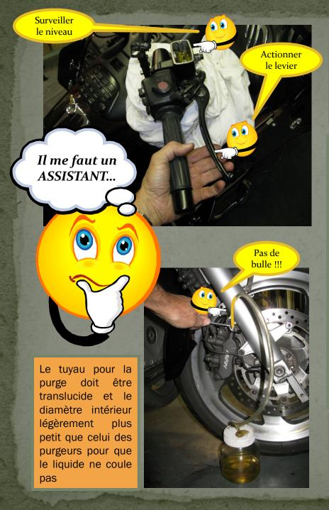
Remplissez le réservoir de liquide de frein DOT 4 provenant d'un bidon non entamé. Vérifiez souvent le niveau de liquide lors de la purge de frein pour éviter que de l'air pompé ne pénètre dans le circuit.
