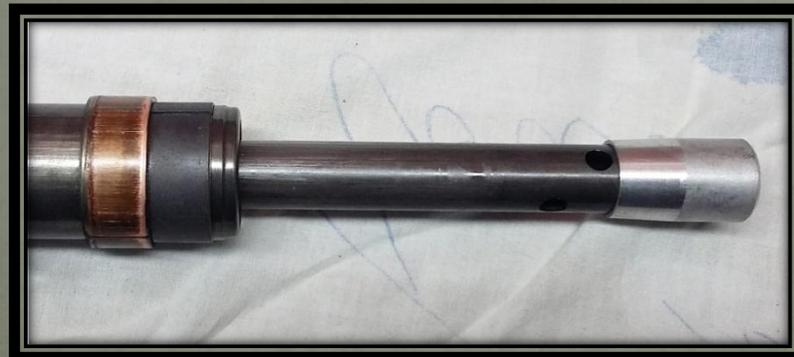
Faire rentrer le tuyau de siège dans le tube en limite de la pièce de retenue d'huile
