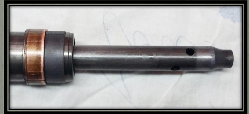
Remettre la pièce de retenue d'huile sur le tuyau de siège
