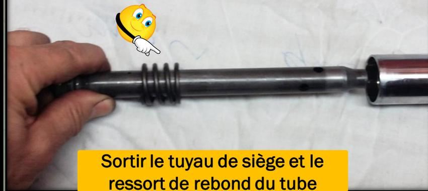
Sortir le tuyau de siège et le
