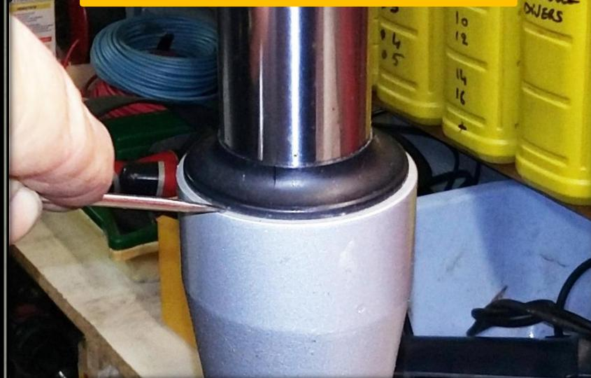
Dépose de l'anneau de butée du joint d'étanchéité
