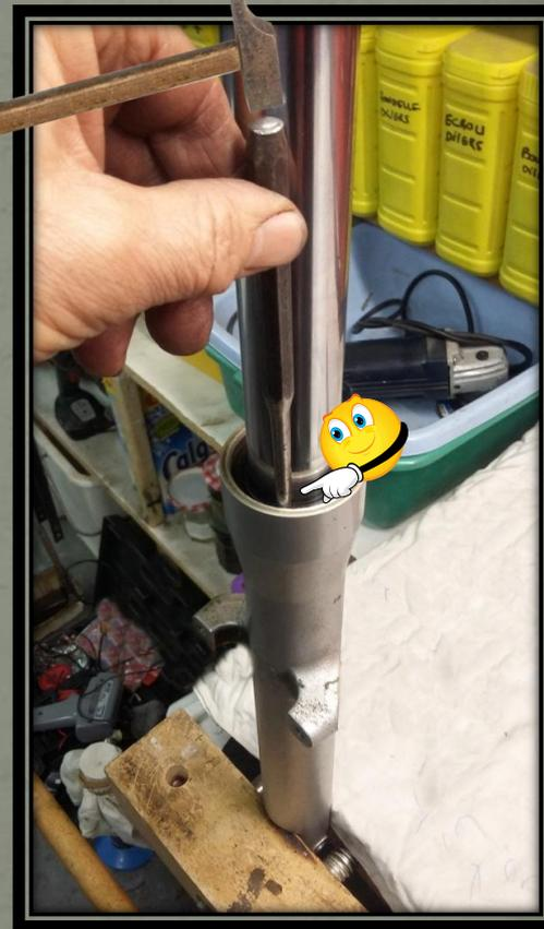
J'ai utilisé un petit marteau en faisant bien attention de ne pas abimer le dessus du joint. Pour le faire descendre dans son logement, j'ai utilisé les vieux joints comme tampons, dont j'ai au préalable meulé la bande noire autour pour qu'ils ne coincent pas dans le logement.
