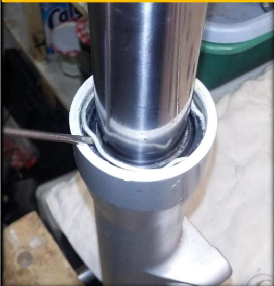
Tenir le boîtier inférieur. Tirer par à-coups sur le tube pour sortir le joint d'étanchéité de son logement
