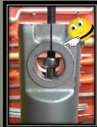
Mise en place du joint d'étanchéité. Je tapote de façon régulière sur le pourtour du joint pour qu'il coulisse le plus droit possible dans son logement. Quand je pense qu'il est bien positionné je continue à le faire descendre au ras du boîtier inférieur. Puis j'utilise les vieux joints comme tampons (pour ne pas l'abimer) et pour finir un jet (avec précaution). Quand je vois que la gorge de l'anneau de butée est dégagée, pour moi le joint est bien en place au fond de son logement.
