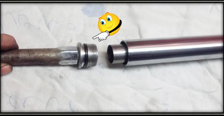
Je mets un joint en cuivre neuf et je visse le boulon de douille sur le tuyau de siège .
