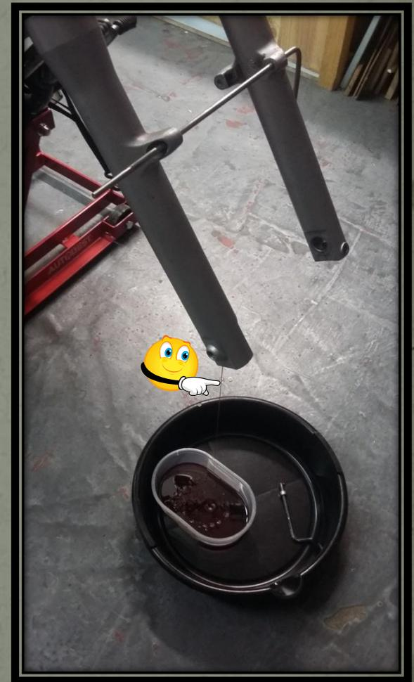
Enlever la tige, desserrer les brides, remonter légèrement les tubes, resserrer les brides, desserrer les boulons supérieurs. Desserrer les brides, descendre et déposer les tubes.
