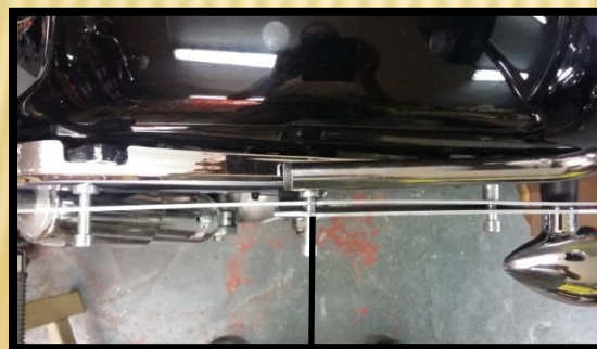
Contrôle des entretoises pour l'alignement des plaques
