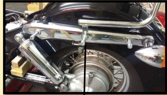
Pose du sissi-bar
