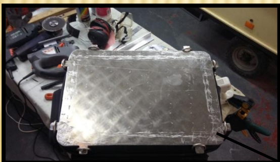
Découpe d'une plaque d'aluminium de 5 mm d'épaisseur avec des épaulements pour les anneaux du sac et des cornières de fixation
