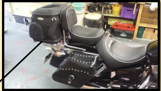
Pose du sac, les anneaux vont dans les épaulements et un petit câble antivol de confection maison passe dans les anneaux sous la plaque
