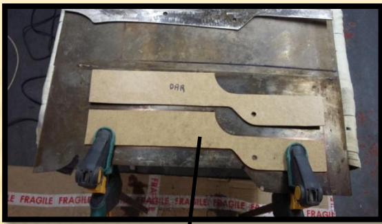
Gabarit des éléments arrière
