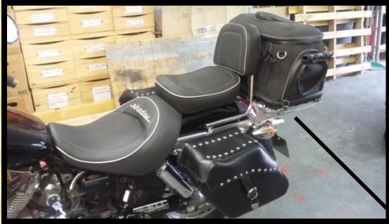
Pose du sac, les anneaux vont dans les épaulements et un petit câble antivol de confection maison passe dans les anneaux sous la plaque
